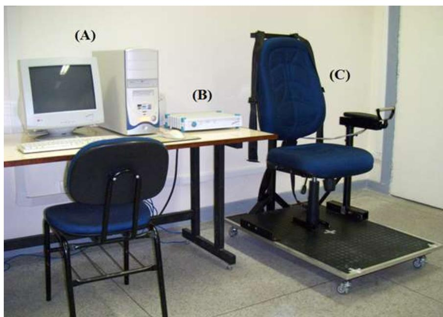
Figura 1 - Sistema de aquisição: (A) computador, (B) Sistema de aquisição e condicionamento de sinais modelo SPIDER 8 e (C) Estação de Medição de Força.
