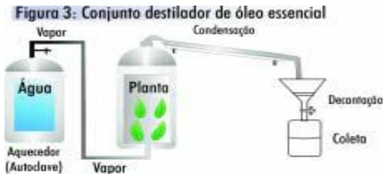
Figura 1 – Obtenção de extrato de manjeriçã por arraste com vapor de água<sup>11</sup>
